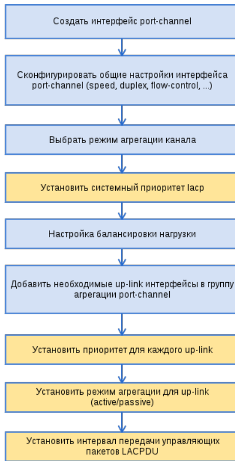
Рисунок 27 – Последовательность настройки LAG и LACP
