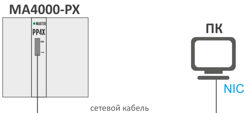
Рисунок 17 — Подключение узла доступа к компьютеру сетевым кабелем
