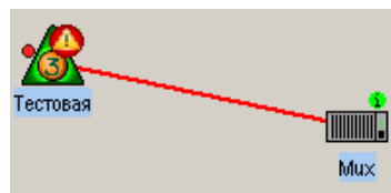
Рисунок 34 – Отображение замаскированных аварий на объекте
